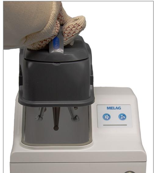
2. Kontrollieren Sie, ob das Carebox-Oberteil korrekt auf der Dichtung der Kühlkammer aufliegt.
