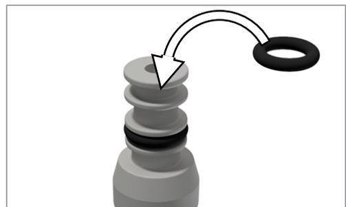
3. Prüfen Sie die Adapterdichtung auf korrekten Sitz.
