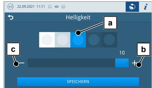
➔ Die Displayhelligkeit kann in zehn Stufen eingestellt werden.
