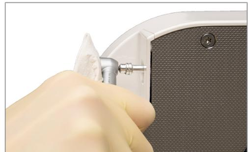
5. Drücken Sie das Instrument so oft kurz auf die Düse, bis Öl am Instrumentenkopf austritt.
