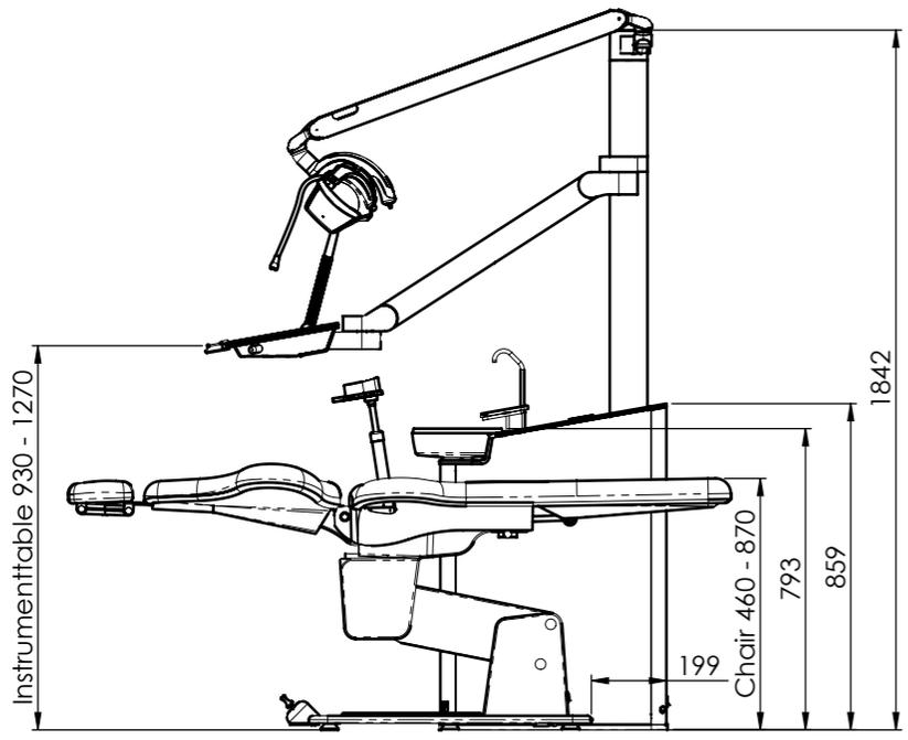
Diese Zeichnung zeigt einer UnicLine S mit integrierter Speifontäne.
