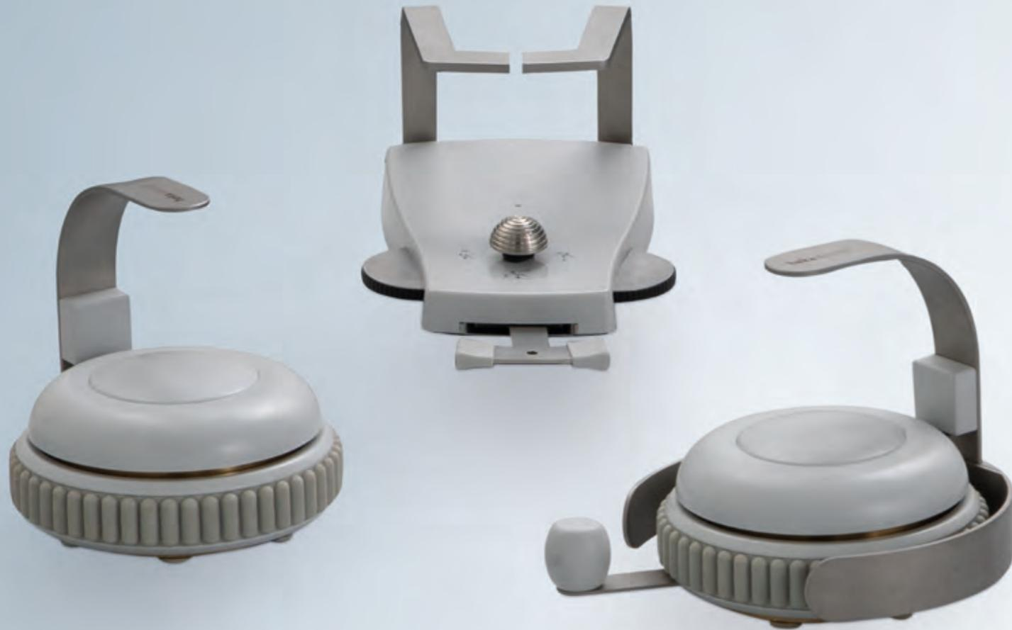
Der patentierte runde Fußanlasser reguliert die Geschwindigkeit und die Intensität der gewählten Instrumente. Ein Druck auf den Zwischenring aktiviert die Spraywahl sowie den kräftigen, mechanischen Chipblower und ändert die Drehrichtung des Mikromotors.
